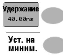
**Примечание:** Функция «**УДЕРЖАНИЕ**» автоматически отключается (становится неактивной) в случае перевода осциллографа в режим **САМОПИСЕЦ** (Roll).
