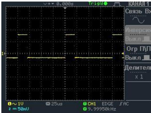
Рис. 8-4а. Инверсия каналов выключена
